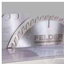
Altura de corte de 102 mm para un disco de sierra de Ø 315 mm
