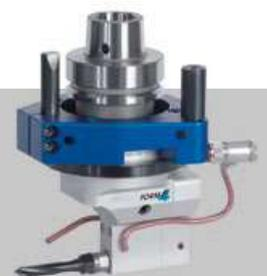
Unidad HSK F63 LowLevel, 1 salida para herramienta de rosca M8 rosca + centrado Ø 9H7, para perforación horizontal en componentes en tableros anidados o directamente en la placa protectora.
