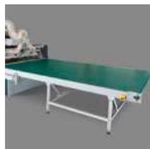
Unidad de descarga automática incl. empujador electromotorizado
