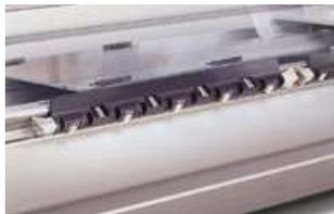
Otro sistema de guía lineal con carga puntual
