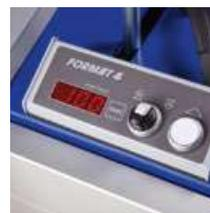
Tope de fresado con ajuste eléctrico
