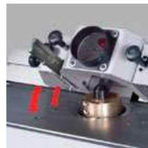
Sistema de MULTI-regulación para una guía paralela y un ajuste rápido.
