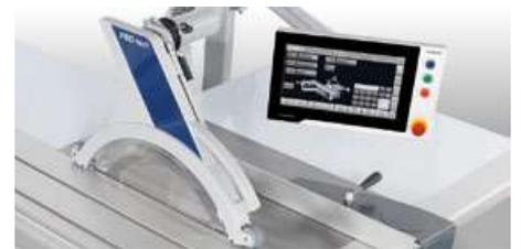
La nueva capota de protección superior y la moderna aspiración bajo la mesa, garantizan resultados perfectos de aspiración. La capota de protección superior de concepción perfecta, se ajusta muy fácilmente en altura gracias a las guías lineales. Las virutas son aspiradas por el flexible situado sobre la capota de protección y se dirigen hacia la tubería rígida.
