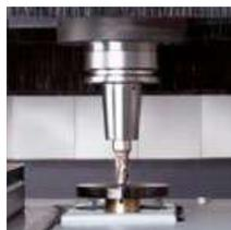
Sistema de medida automático de longitudes de la pieza
