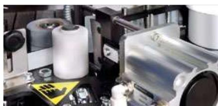
**5** Tijera cizalla con corte preliminar neumático
