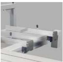
Tope de corte paralelo con control de posicionamiento
