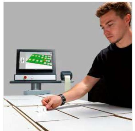
La unidad de evacuación integrada en el portal empuja después del mecanizado, las piezas acabadas y a la vez limpia la mesa. Los restos de virutas se remueven con la aspiración por debajo de la mesa. Durante el proceso de empuje se imprime la primera etiqueta y se clasifica la pieza según el color de la etiqueta en la pantalla de etiquetado. Este proceso se repite pieza por pieza.
