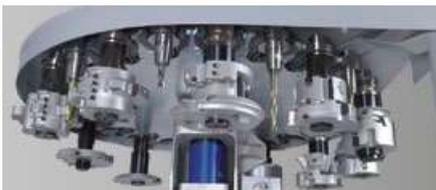
**3** Cambiador circular con desplazamiento sobre brazo
