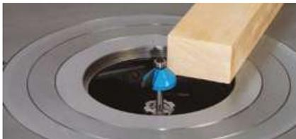
En el cambio de eje de tupí, el probado sistema de cambio rápido de eje de tupí garantiza la máxima productividad. Ejes de tupí con diferentes diámetros y herramientas premontadas para trabajos en serie pueden usarse en cuestión de segundos.
