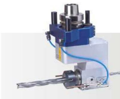
El agregado para cerraduras HSK F63 con 1 salida ER 32 para herramienta de taladro o de tupí con dos boquillas de aire comprimido y 1 salida trasera ER 16 para herramienta de taladro y tupí
