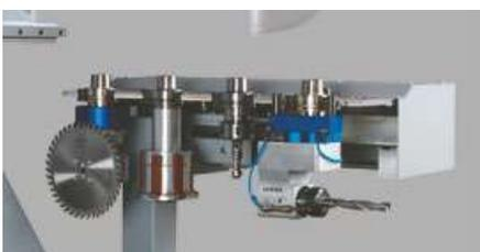
**2 Cambiador lineal de 4 posiciones con desplazamiento en eje X móvil.**
