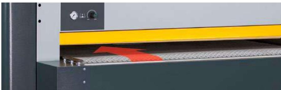
La velocidad de alimentación se puede ajustar infinitamente en el panel de control entre 2,8 y 20 m/min.
