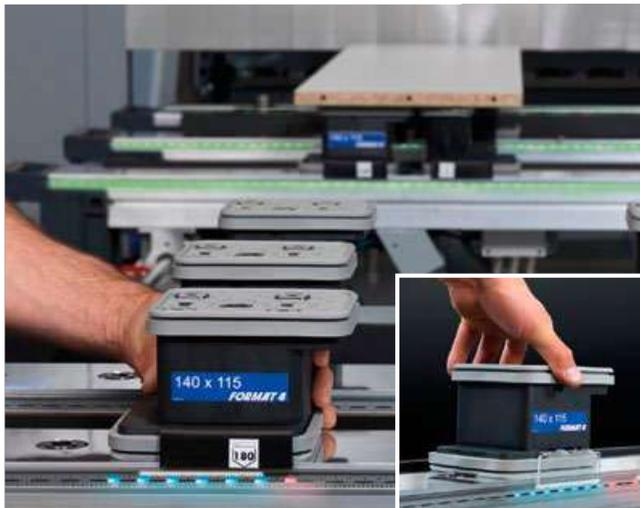
Sistema de doble circuito de aspiración sin cámara de FORMAT4 con altura de aspiración de 100 mm
