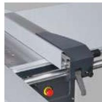
Tope profesional de escuadradora con guiado sobre eje cilíndrico
