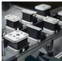
Sistema de doble circuito de aspiración sin cámara
