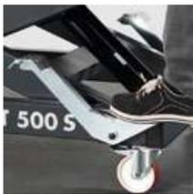
Pedal con sistema hidráulico ergonómico y fácilmente operable desde tres lados
