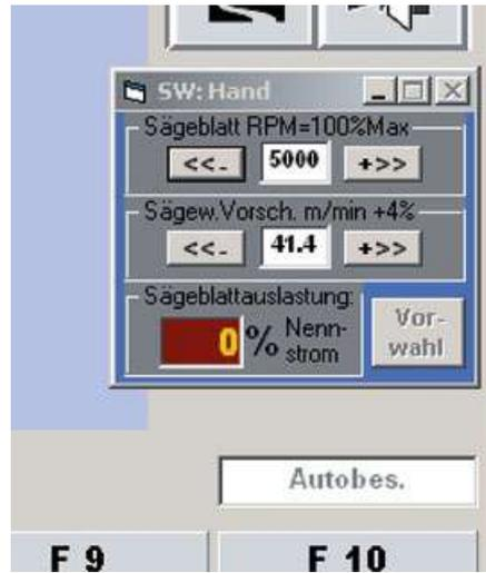
Ajuste de velocidad variable para la sierra principal entre 2.000 e 6.000 rpm
