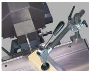
El tope angular se fija en segundos con la palanca manual en la mesa de la máquina. Los ángulos más usados son  $-45^\circ$ ;  $-22,5^\circ$ ;  $0^\circ$ ;  $22,5^\circ$  y  $45^\circ$  se seleccionan con a trama de trinquete, todos los otros ajustes angulares se eligen con la escala.
