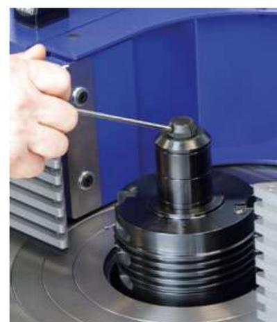
A pedido: el tope de fresado se fija con el movimiento de la mano y se suelta nuevamente. Accionando la palanca de sujeción rápida se puede fijar fácilmente el tope de fresado sin esfuerzo en la posición deseada y luego soltarlo nuevamente.
