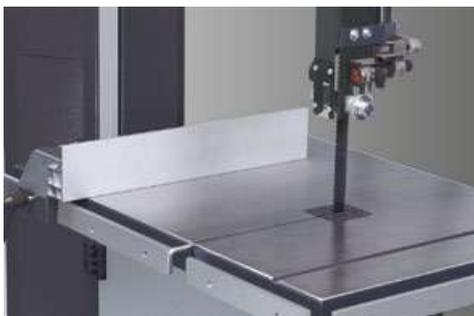
El deslizamiento fácil de la guía de corte de aluminio es del lado izquierdo y derecho de la hoja y se puede utilizar para piezas de trabajo planas que fácilmente se doblan hacia abajo.
