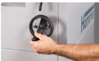
La mesa de trabajo estable hecha de hierro fundido gris puede ajustarse convenientemente a mano en 150 mm de altura. La mesa tiene una ranura en T en toda la longitud de la mesa.
