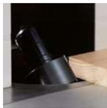
Inclinación del eje de fresado hacia atrás
