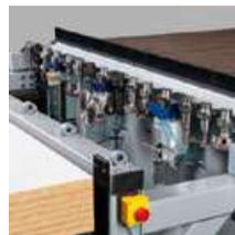
Cambiador de herramientas ajustable en altura, incluida la cubierta
