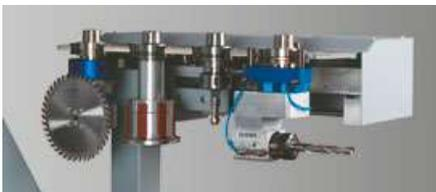
**2** Cambiador lineal de 4 posiciones con desplazamiento en eje X móvil (H350).
