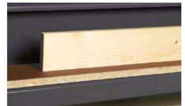
El apoyo de lijado superior está provisto de un revestimiento de grafito. De esta manera es posible lijar cantos de piezas pequeñas y también efectuar trabajos de lijado especiales con la lijadora de banda.
