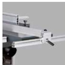
Tope de corte paralelo en la mesa de sierra circular (ajustable entre 0-900 mm)
