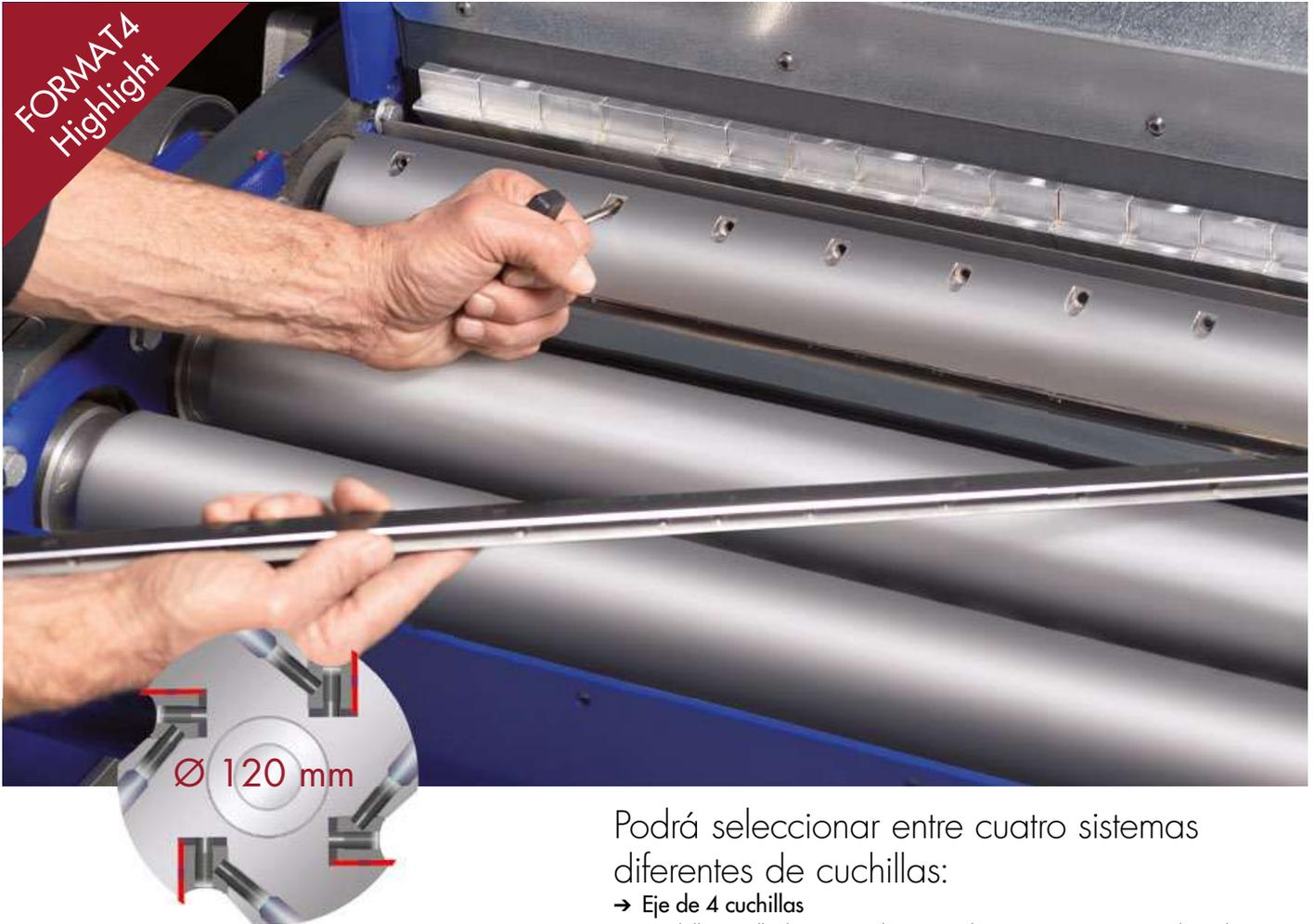
Podrá seleccionar entre cuatro sistemas diferentes de cuchillas:
