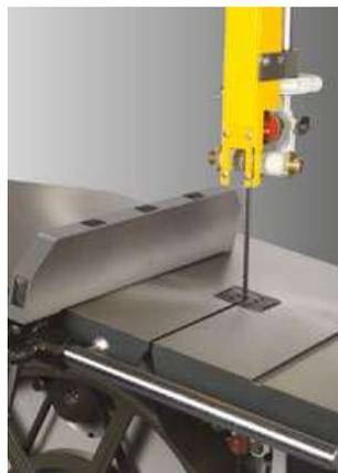
Mesa de sierra de cinta en fundición de acero, inclinable de  $0^\circ$  hasta  $+20^\circ$  con superficie lijada de gran precisión.
