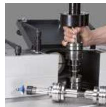
Sistema de cambio rápido de eje
