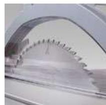
Altura de corte 133 mm, 3 velocidades (3500/4500/5500 rpm)
