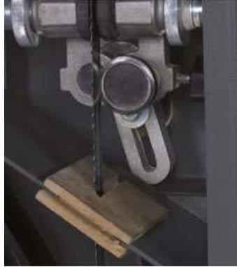
Las sierras de cinta Felder llevan una guía de hoja superior e inferior con rodillos laterales y traseros, y un tornillo de ajuste del tope.
