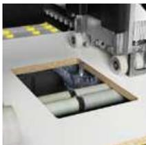
Para el fresado de recortes, bolsillos, ranuras y rebajes en la pieza
