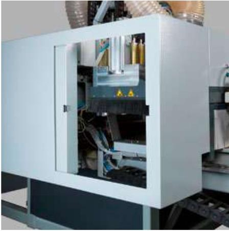
La puerta de mantenimiento en la parte posterior de la capota hace que la unidad de perforación sea fácil, rápida y accesible desde el punto de vista ergonómico.
