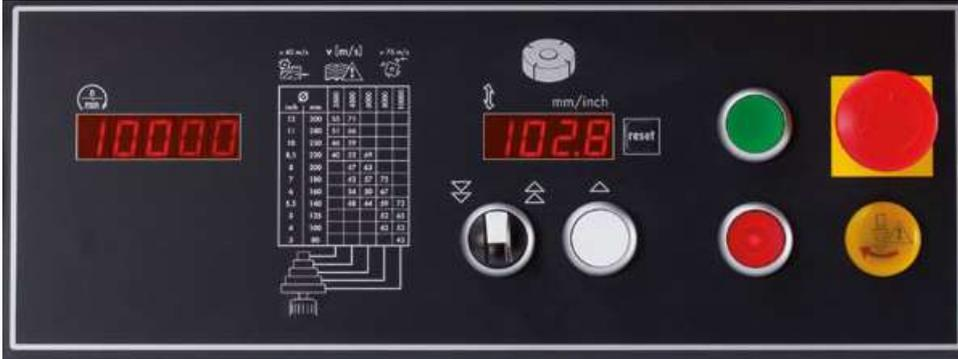
Precisión milimétrica a la décima de mm del eje de la tupí con botón giratorio, velocidad lenta para un ajuste fino. Display LED rojo para el valor real de la altura del eje. auf SPA Inclinación del eje de tupí por encima del volante y reloj digital integrado. La serie -900 también dispone de un contador digital de revoluciones por minuto.
