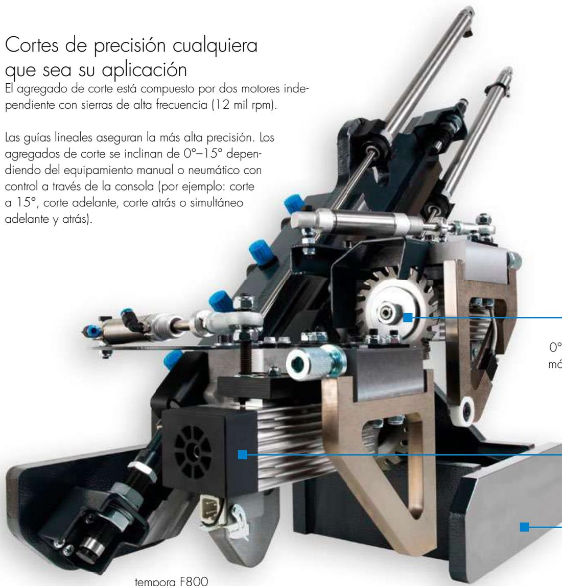
Sierras de corte de 0°-10° y 0°-15°; inclinación manual o neumática; unidad de corte en 45° / con equipamiento de radio
