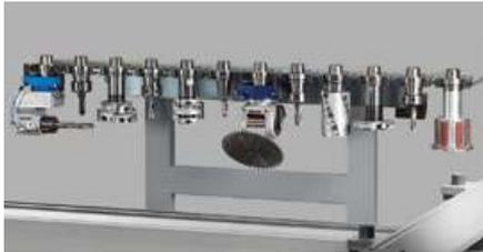
**5** Unidad de longitud de la herramienta de medición. La unidad de medición automática de longitud garantiza la medición de la longitud de la herramienta en centésimas de milímetro directamente en la máquina y reduce los errores de medición por parte del operador de la máquina.
