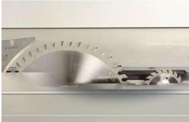
El disco incisor no tiene juego, se ajusta en altura y en ancho y tiene una potencia de 1,0 CV (perform)
