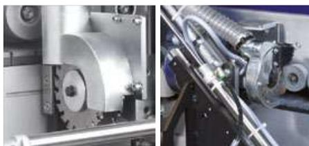
**8** Agregado de corte final lineal
