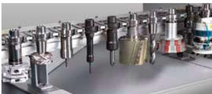
**1** Cambiador lineal montado en el bastidor de la máquina.
