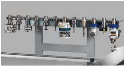
**4** Cargador lineal con 12 posiciones montado sobre el bastidor de la máquina. El cambiador de herramientas con 12 posiciones aumenta la productividad y crea más espacio para herramientas adicionales en la máquina.
