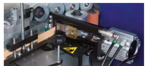
**6** Tijera cizalla con corte preliminar neumático
