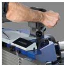
Tope de fresado con sistema de sujeción rápida
