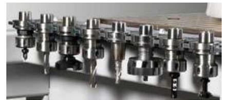
**1** Cambiador de herramientas con 8 o 11 posiciones sobre el lado lateral del bastidor de la máquina
