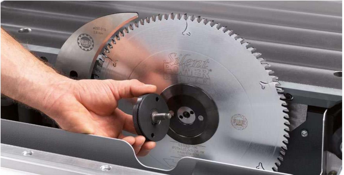
¡Sustitución de la cuchilla de corte sin herramientas y con seguridad: el sistema libre de mantenimiento ofrece un confort único!
