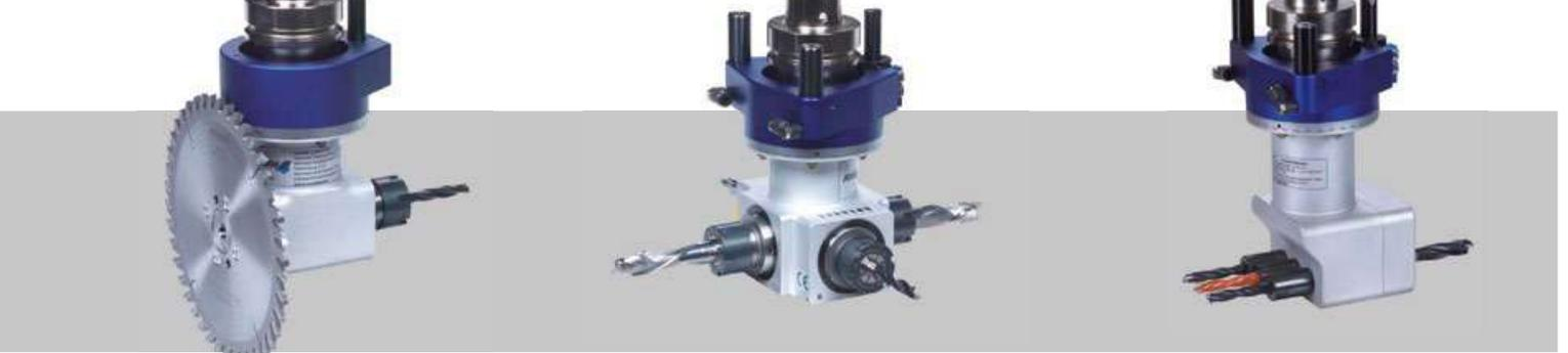
Cabezal angular doble HSK F63 con 1 salida ER 25 para herramientas de taladro y tupí y 1 salida WELDON con disco de corte máx. Ø 180 mm
