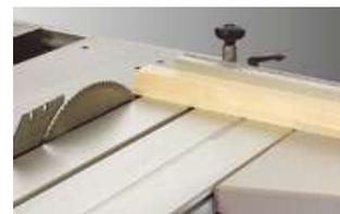
Ajuste del ángulo entre 90° y 45° con escala precisa
