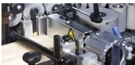
**5** Tijera cizalla con corte preliminar neumático (la imagen incl. cargador de bandas estándar)
