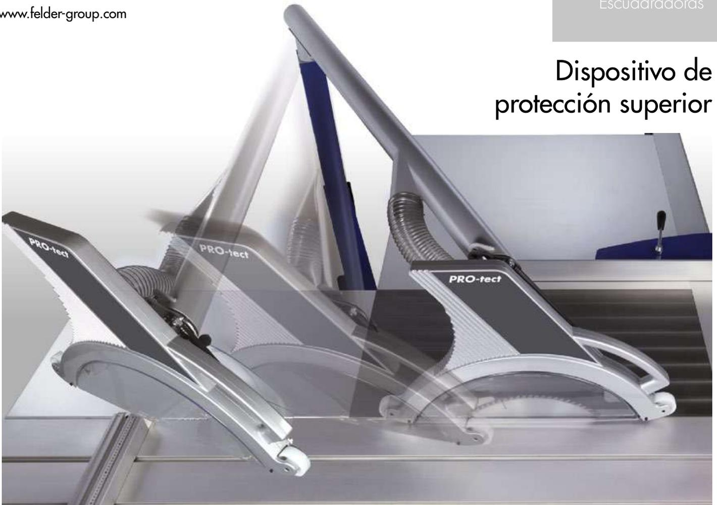
La protección superior Format4 está muy bien integrada en el diseño de la máquina. El manejo es simple y cómodo. Se puede desbloquear y bascular la protección superior con la manija de mando en el área de las mesas. La capota de aspiración se adecua automáticamente a la altura de corte utilizada y ofrece siempre seguridad laboral y potencia de aspiración.
