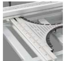
Sistema de graduación INDEX con compensación longitudinal
