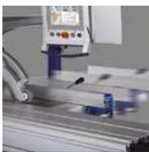
Control de posicionamiento de la regla de corte paralelo
