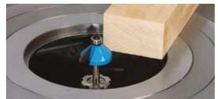
El eje de tupí de alta velocidad acepta todas las fresas de vástago con un diámetro de 6 a 16 mm. Velocidad: 15.000 rpm, para una potencia del motor máx. de 13,5 CV.
