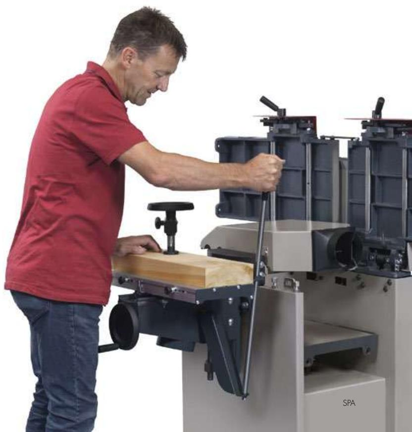
Para abrir orificios y entalladuras puede equipar su Hammer a pedido con un taladro-escoplo.
