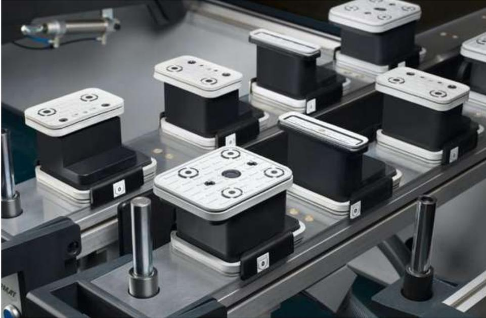
Sistema de doble circuito de aspiración sin cámara de FORMAT-4 con altura de aspiración de 100 mm
