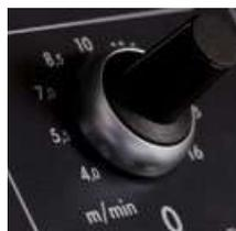
Ajuste libre de la velocidad del alimentador 4–16 m/min
