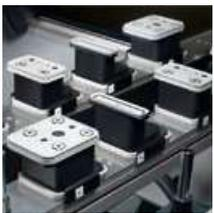
Sistema de doble circuito de vacío con ventosas sin tubos de
