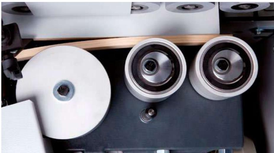
El cargador de cantos para la alimentación automática de materiales en tiras (dependiendo del equipo hasta 120 mm) aumenta la flexibilidad del cliente en todos los modelos.
