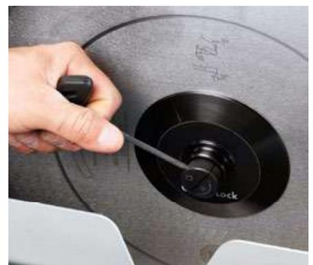
Simple, seguro y rápido. Sujeción "Quick-Lock" de disco de sierra.
