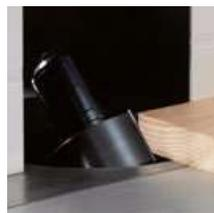
Inclinación del eje de fresado hacia atrás
