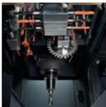
Máxima potencia con husillo principal de 12 kW y cabezal con control en continuo
