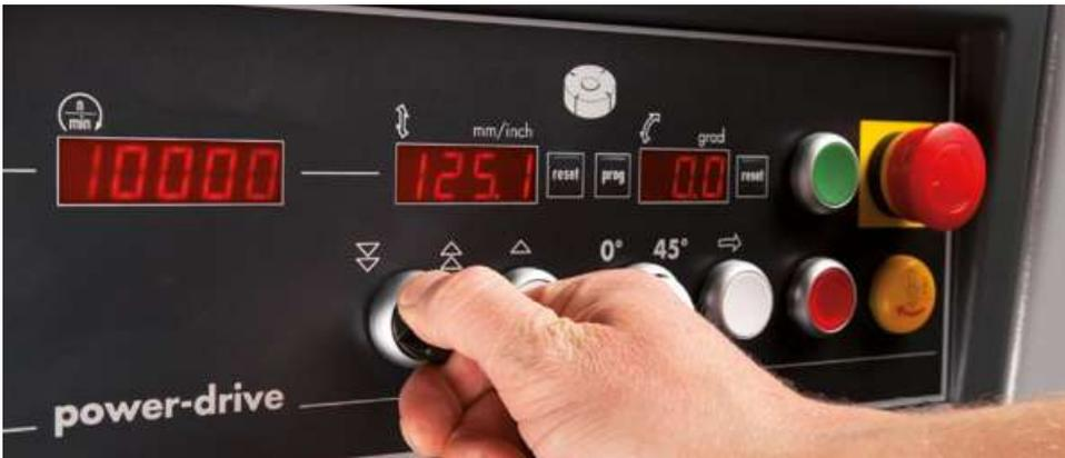
El control "Power-Drive" totalmente electrónico, ofrece el ajuste y la precisión en las repeticiones más exactas. Girando un botón usted regula la altura y el ángulo del eje de fresado, el ajuste fino lo realiza con exactitud de décimas de milímetro pulsando un botón. Las cifras del indicador LED le indican en la pantalla de control y en tiempo real el valor efectivo. La serie 900 también dispone de un contador digital de revoluciones por minuto.
