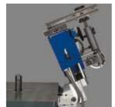
Dispositivo pivotante del tope de fresado
