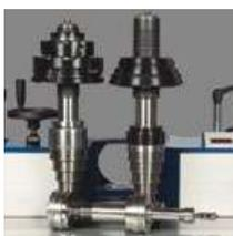
Sistema de cambio rápida del eje de la tupí
