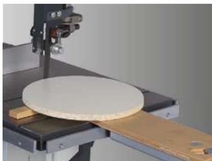
Dispositivo de corte circular: Prolongación de mesa con pie de soporte
