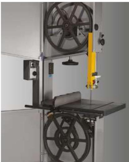
Las sierras de cinta Felder llevan una guía de hoja superior e inferior con rodillos laterales y traseros, y un tornillo de ajuste del tope.
