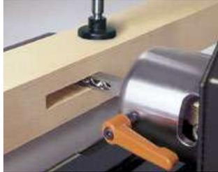
La realización de agujeros cuadrados o rectangulares no supone ningún problema con este portabrocas especial. Ya no hace falta redondear la espiga porque se puede escoplear de manera "angular". Así, se puede evitar trabajos manuales que requieren mucho tiempo.
