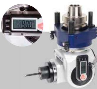
HSK F63 unidad inclinable con 1 salida ER 25 para herramienta de taladro, de fresado o de sierra, máx. 240 mm, ajuste angular y trabamiento rápido.
