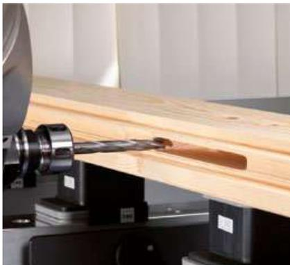
Cabezal para trabajos horizontales
