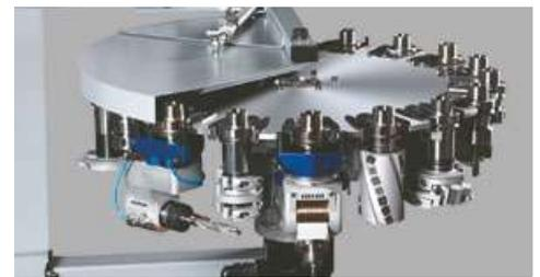
**3 Bandeja de cambio de 18 herramientas con desplazamiento sobre brazo.**
