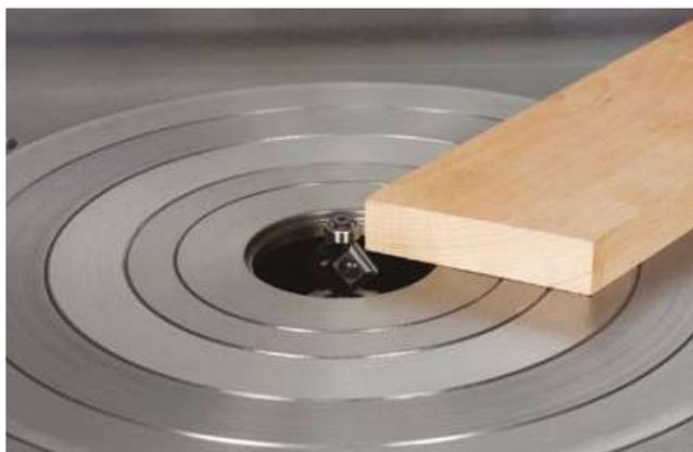
El eje de tupí de alta velocidad acepta todas las fresas de mango con un diámetro de 6 a 16 mm. Velocidad: 15.000 rpm, para una potencia del motor máx. de 10 CV.
