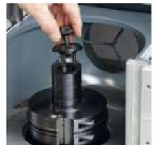
"Quick-Lock" - Cambio de herramientas de fresado en forma rápida y segura
