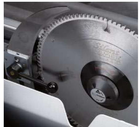
Rápido, fácil y sin herramienta alguna: ¡El cambio del disco de sierra de la nueva Format4 es sencillamente sensacional! Gracias al sistema patentado de transmisión de energía, se genera la fuerza de presión necesaria en la brida. Una palanca de apriete consigue la fijación sin herramientas de la cuchilla divisora. ¡Seguridad absoluta y máxima productividad garantizada con Format4!
